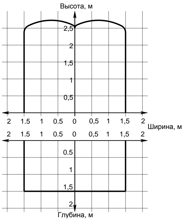
**Схема размещения дренчерных горизонтальных оросителей «ДВГ-10», «ДВГ-12» для водяных завес**
