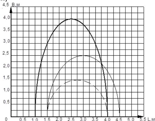
Графики зависимости средней интенсивности орошения от давления (вода, пена) при установке оросителей вертикально вниз
