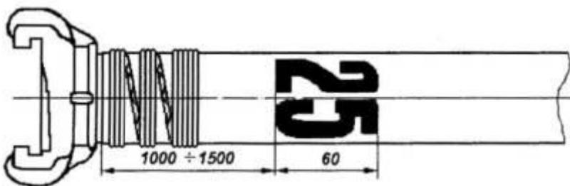
Рис. 4. Дополнительная маркировка рукава на рукавной базе
