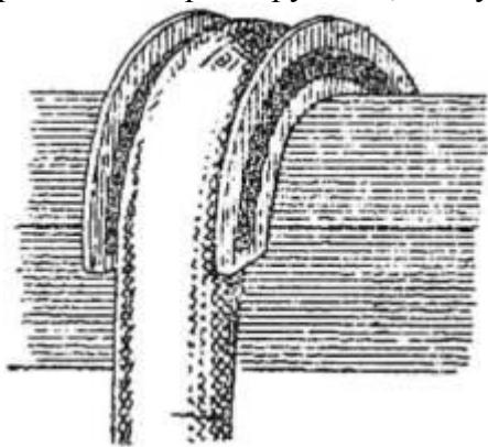
Рис. 7. Использование рукавного колена
