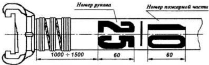
Рис. 3. Дополнительная маркировка рукава в пожарной части
