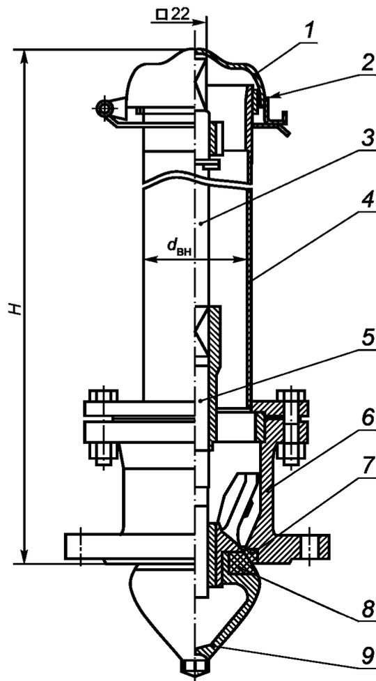
1 — крышка; 2 — nipple; 3 — штанга; 4 — корпус; 5 — шпindel; 6 — патрубок; 7 — седло; 8 — кольцо уплотнительное;
