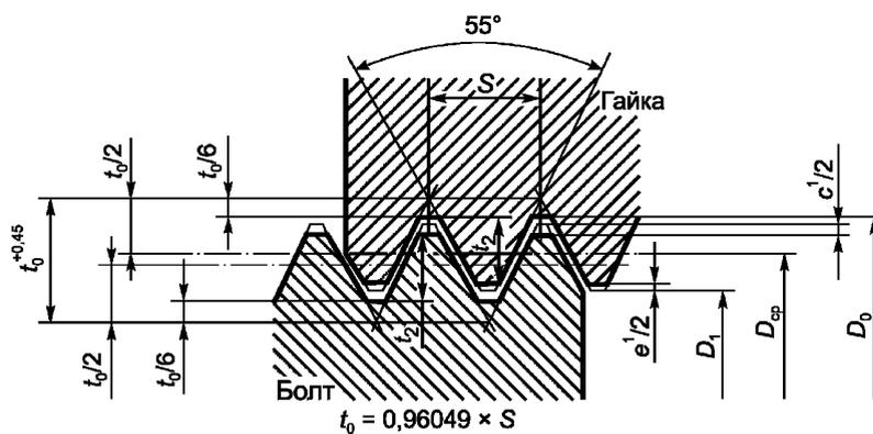
Рисунок Б.1 — Внутренняя резьба резьбового кольца
